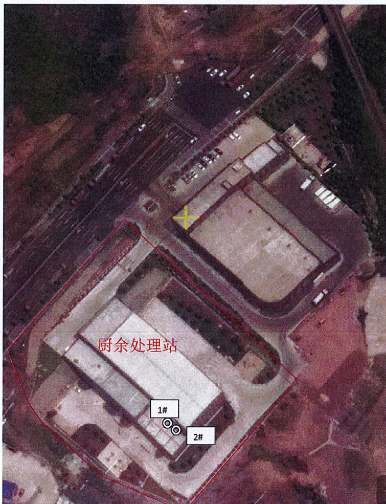
图例：◎ 表示有组织废气采样点
